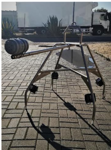
Figura 1 | Aspecto do sistema BRUV desenvolvido pelo Politécnico de Leiria para amostragem de megafauna marinha nas Berlengas.
